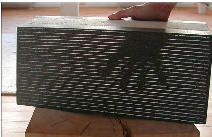
Figur 18: Gennemskinnelig beton med mellemliggende isolering
